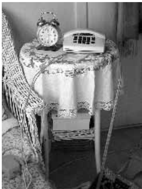
Figur 4:8 Ombyggd telefon med luftslingor till luren från högtalare, mikrofon och annan nödvändig elektronik som placerats utanför telefonenheten. Batterilös klocka håller reda på tiden.
