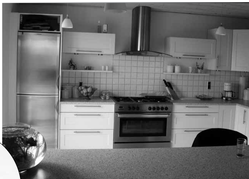
Figur 4:2. Vid starka reaktioner på magnetfält kan elspisen bytas ut mot en gasspis som drivs med gasol, och motorn till köksfläkten placeras utanför huset.
